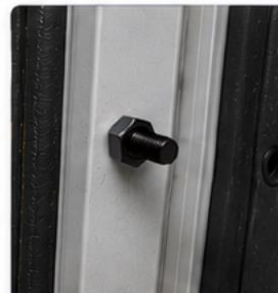
4 Magnetkontakt einschrauben und mit Mutter kontern (max. 1Nm)
